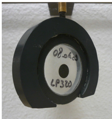
FIG. 2.8 – Cible LP320 montée sur son support.
