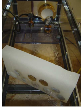
FIG. 2.10 – Photo de l'absorbant acoustique en paraffine lesté par du laiton.
